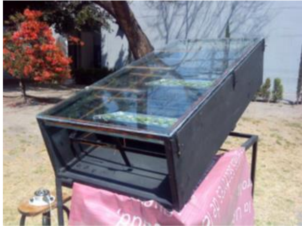
Figura 1 Secador solar con 5 charolas
